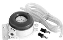
Pressostat permet l'enclenchement d'une alarme d'absence de débit d'air par baisse de pression différentielle ou d'une alarme d'encrassement de filtre par augmentation de la pression différentielle.
